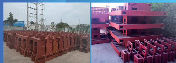
机身、底座等核心铸件选用台湾大厂并经时效处理
